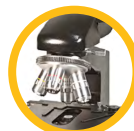
Револьверная насадка с объективами
